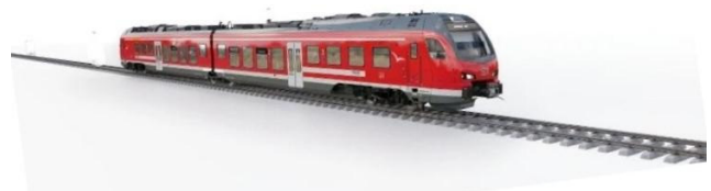
Batteriezug im Bereich ohne Oberleitung
